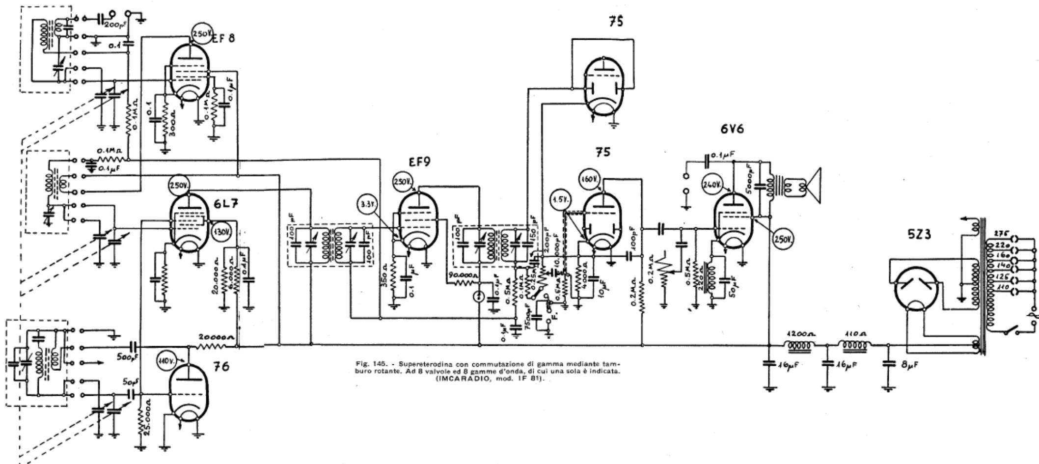
Fig. 145. - Supereterodina con commutazione di gamma mediante tamburo rotante. Ad 8 valvole ed 8 gamme d'onda, di cui una sola è indicata. (IMCARADIO, mod. IF 81).
